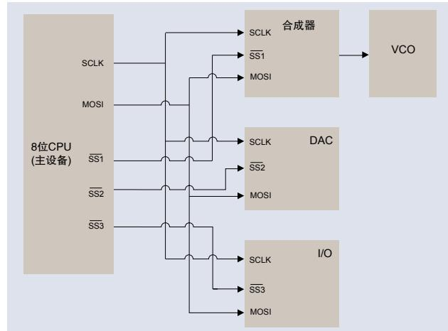
图 11. 通过 SPI 控制的合成器。
