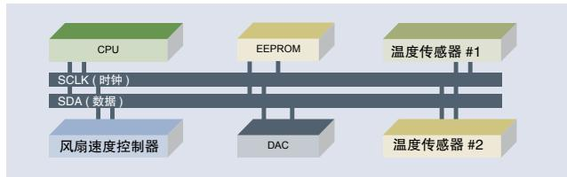
图 6. I<sup>2</sup>C 总线实例。
