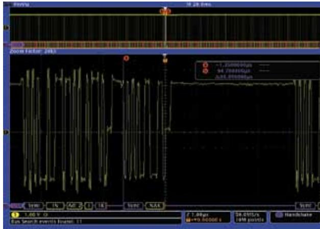
图 22. 全速存储器设备对光标 A 处主机第一个 IN 令牌请求应答 NAK。
