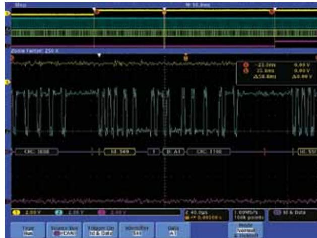
图 31. 触发 CAN 总线上的特定标识符和数据，解码采集中的所有消息。
