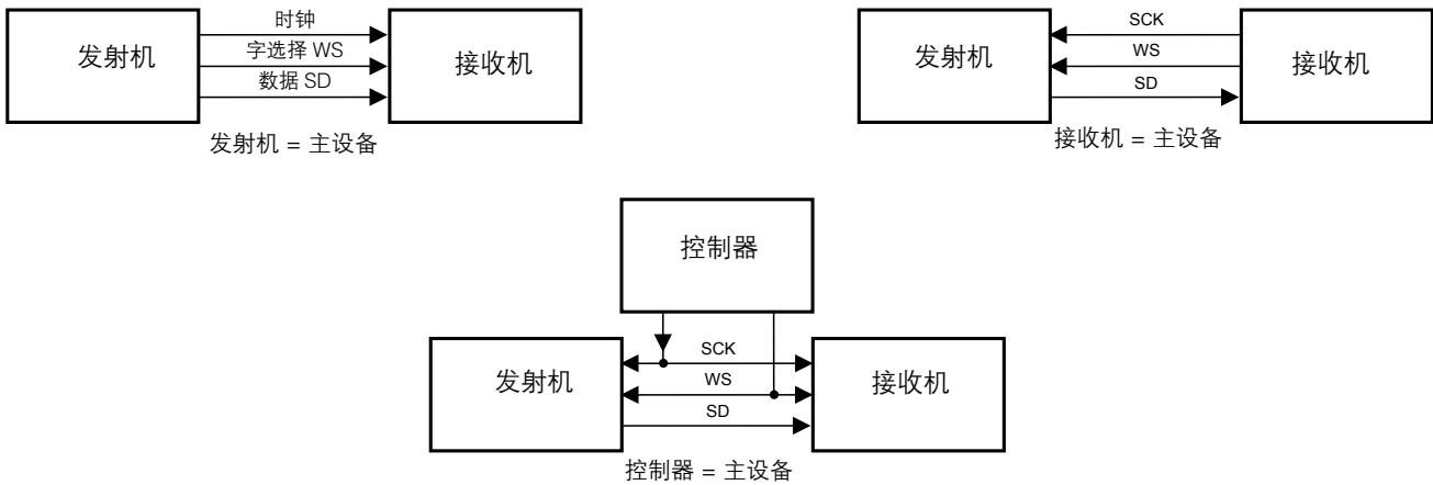
图 45. 不同的 I<sup>2</sup>S 总线配置。
