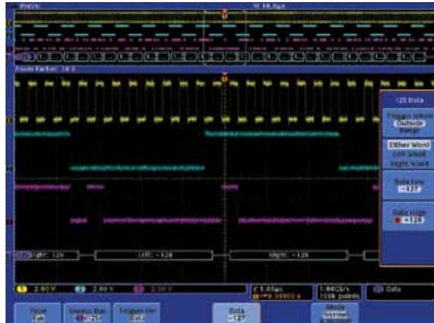
图 48. 在 I<sup>2</sup>S 总线上落在取值范围时触发采集。
