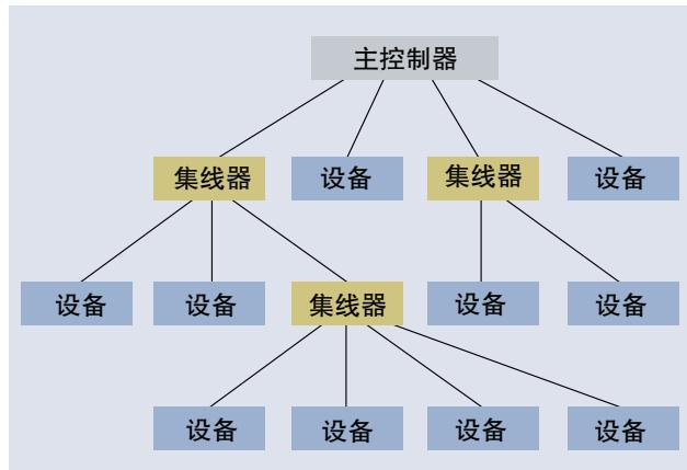
图 14. USB 分层星形拓扑采用集线器，扩展了总线。
