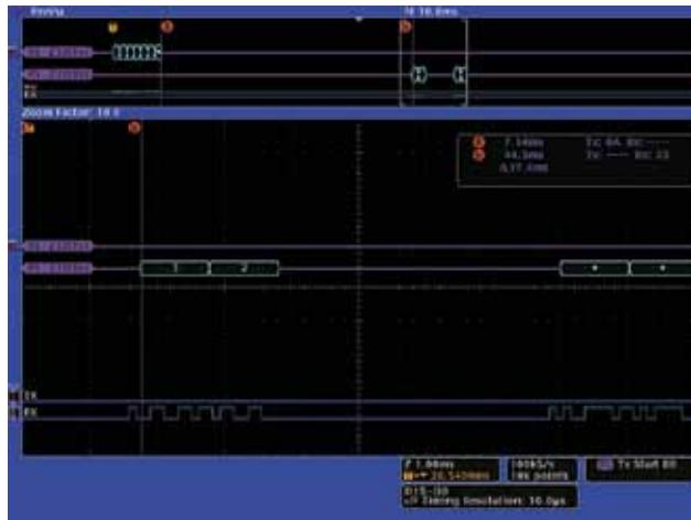
图 28. 测量两条 RS-232 总线上的消息时延。
