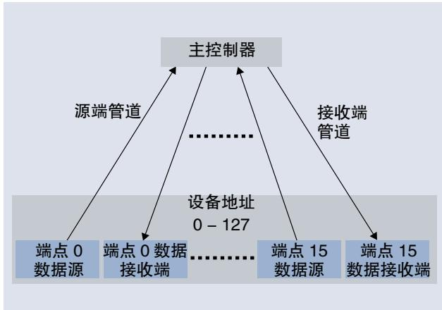
图 15. USB 端点是设备的数据源和数据接收端，拥有到应用软件的逻辑管道。
