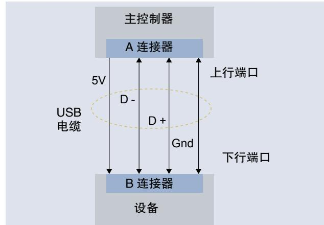
图 16. USB 4 线电缆在上行端口采用“A”连接器，在下行端口采用“B”连接器。
