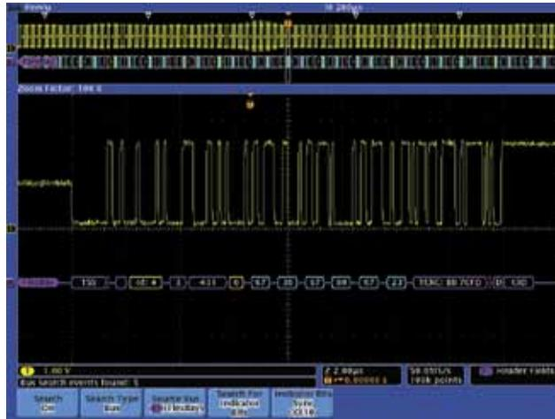
图 42. 触发帧号和循环数，搜索采集的数据，找到启动帧。
