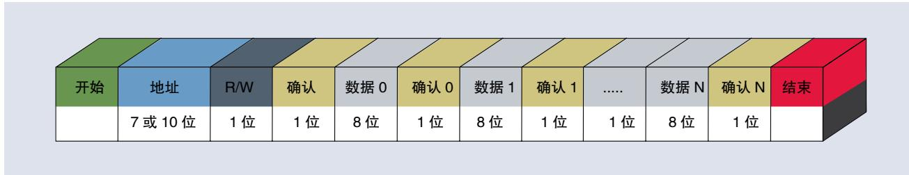
图 4. I<sup>2</sup>C 消息结构。
