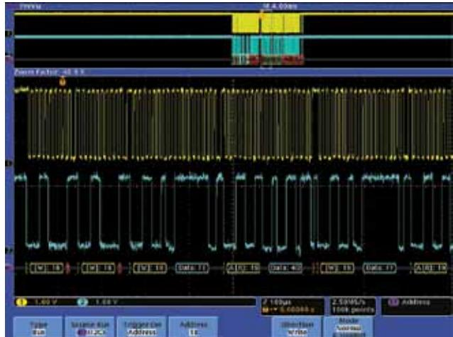
图 7. I<sup>2</sup>C 地址和数据总线波形解码。
