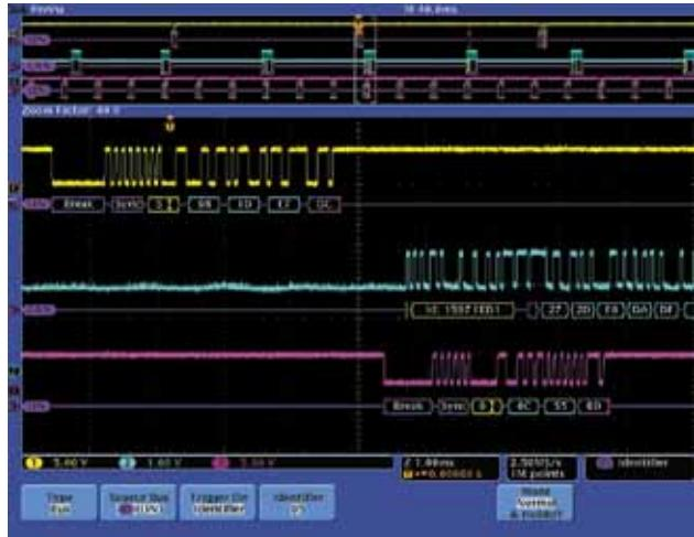
图 35. 触发帧号和循环数，搜索采集的数据，找到启动帧。
