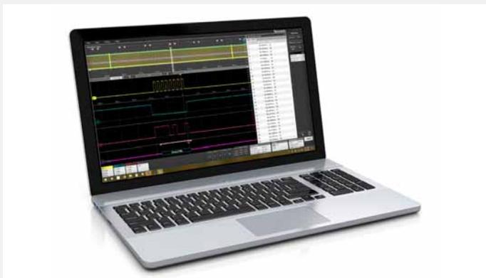
TekScope 在 PC 上仿真 4 系、5 系或 6 系运行。入门许可可以查看和分析波形，进行测量，远程接入示波器，解码 I2C、SPI 和 RS-232。
