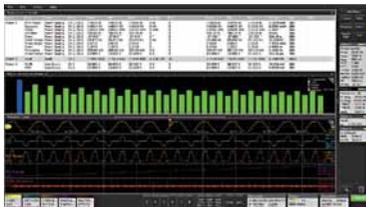
功率分析套件可以自动测量谐波、开关损耗和其他关键参数。
