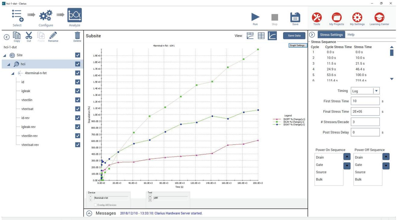
图 3. 实时数据显示的 HCI 测试
