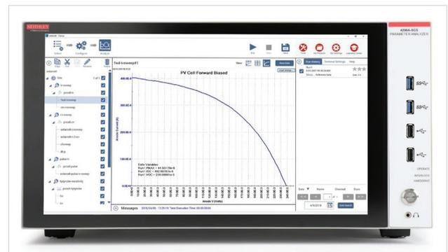
图 11 - 4200A-SCS 参数分析仪测量的太阳能电池正偏 I-V 特性
