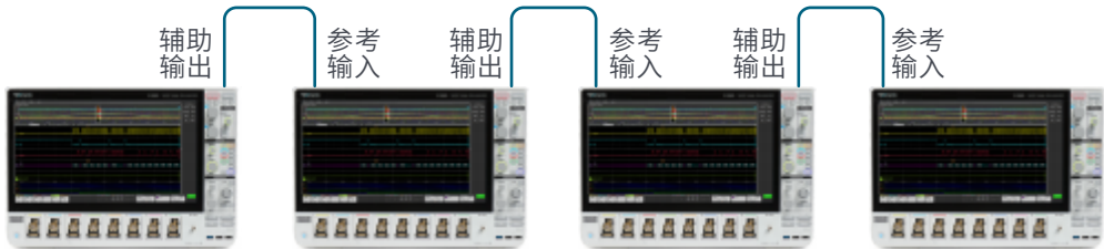
图 5: 使用来自一台波器的时基参考来馈送其他示波器。
