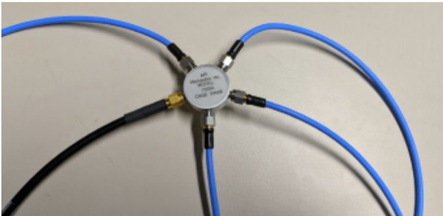
图 4: 一个 SMA 功率分离器, 连接到四根匹配的电缆和一个触发源
