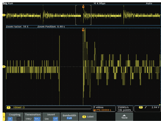
图 2. 显示了 MDO4000C 示波器的谐振现象 (分辨率为 8 位)
