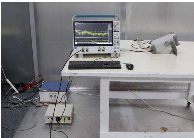
图 6. 典型的传导发射测试设置
