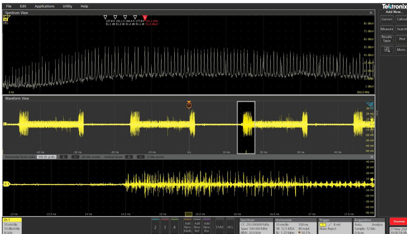
图 9. 当频谱时间移至时间域中的嘈杂数字脉冲时，电磁干扰增加了 20 dB。
