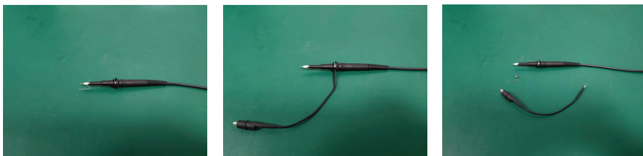
图 9. 示波器自带长接地线、短弹簧地线
