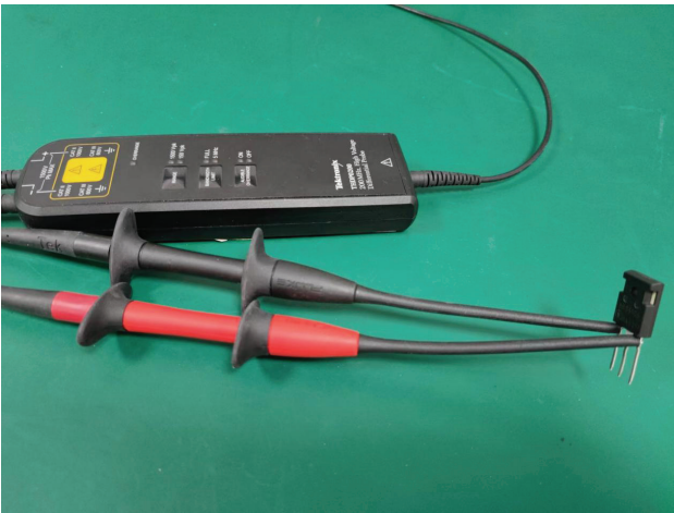
图 14. 探头接引脚根部与远离根部
