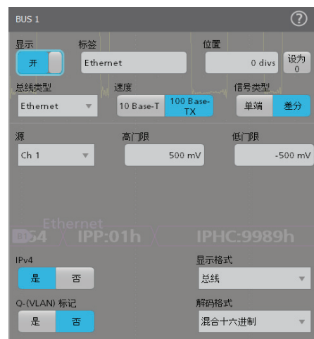
图 8: 100 Base-TX 解码设置
