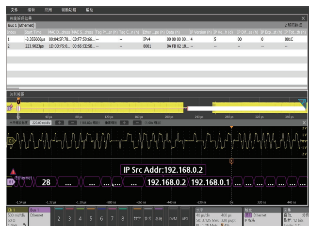
图 12：示波器捕获并解码的 ping request 数据包
