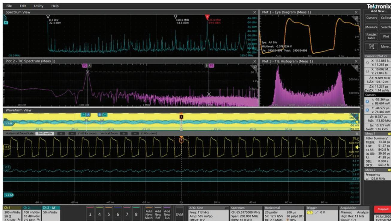
图 8: (a) 电源轨道纹波频谱和 (b) TIE/ 抖动频谱。
