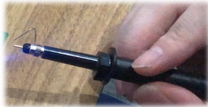
图 9: 探头的探针和接地弹簧
