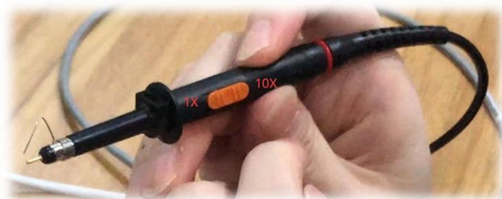
图 6：示波器电压探头衰减设置开关
