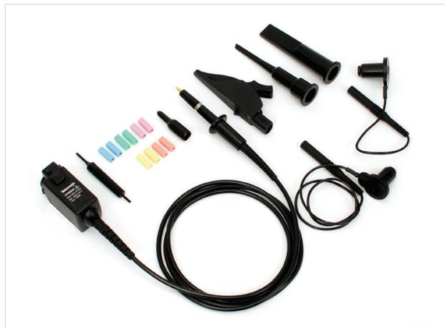
图 5. 泰克 TPP0850 电压探头：单端，参考地电平探头，支持 50x 衰减 (高达 100VRMS) 及 800 MHz 带宽。
