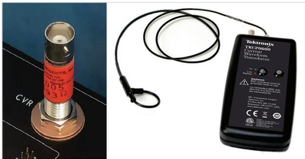
图 7. 探头实例：(a) 电流查看电阻器 (T & M Research SSDN-005, 400 MHz)。图片由 WolfSpeed 提供，获准重新印刷。(b) Rogowski 电流探头 (TRCP0600 电流波形变送器, 30 MHz)。
