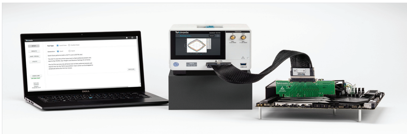
图 5：PCIe 性能综合测试仪（中间），CEM 金手指适配器（右侧），PC 上通过网络访问得到结果（左侧）
