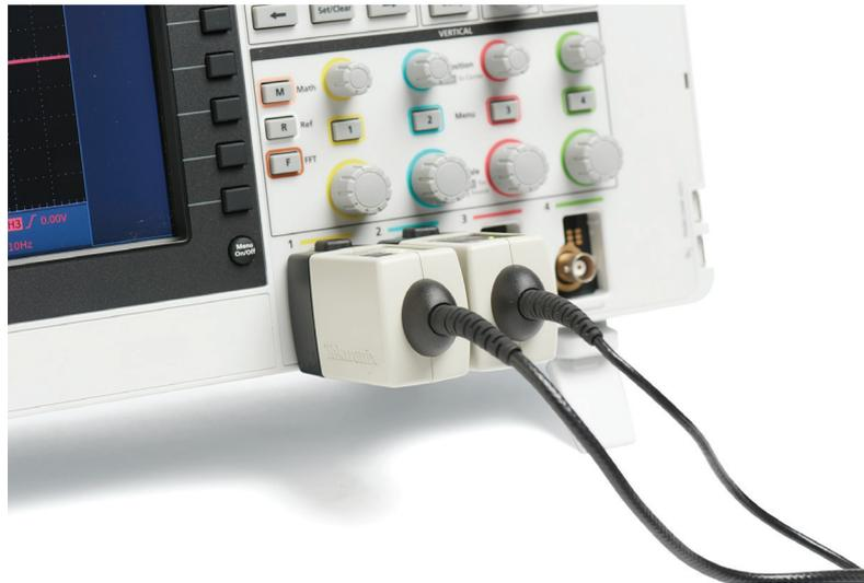
这些示波器的内部电源为示波器前面板输入（通道 1, 2, 3, 4, Aux In 和 RF）的 TekVPI 探头供电。由于这些 TekVPI 探头工作时会需要一定的功率，因此在使用多只探头时可能会超出示波器能提供的内部功率。
