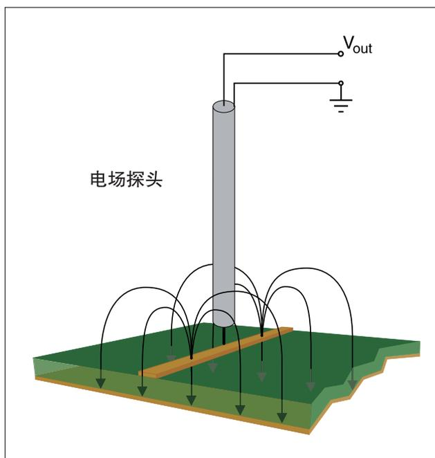
图 8. 使电场探头与导体垂直，以观察电场。
