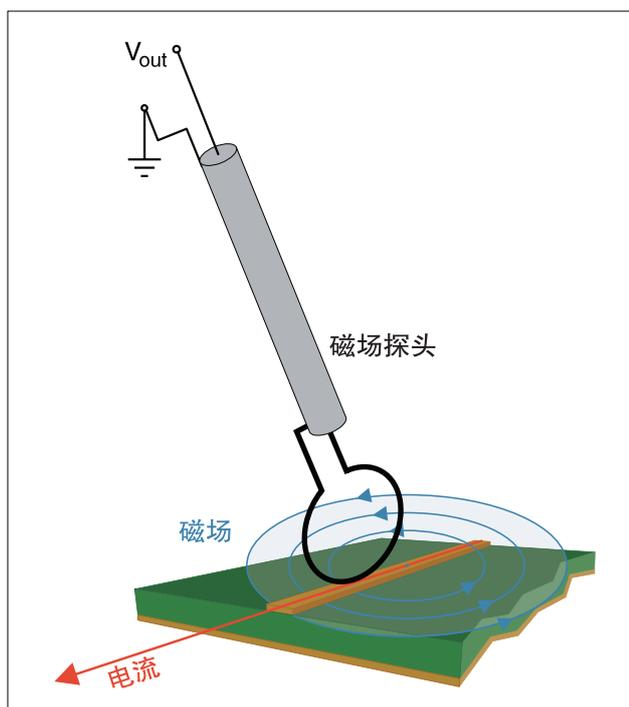
图 7. 使磁场探头与电流流向成一线，以便磁场线穿过环路。
