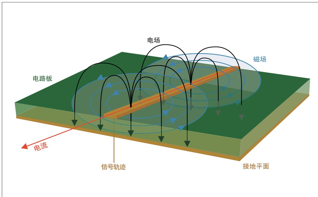
图 6. 构成信号的电压和电流变化导致电场和磁场。
