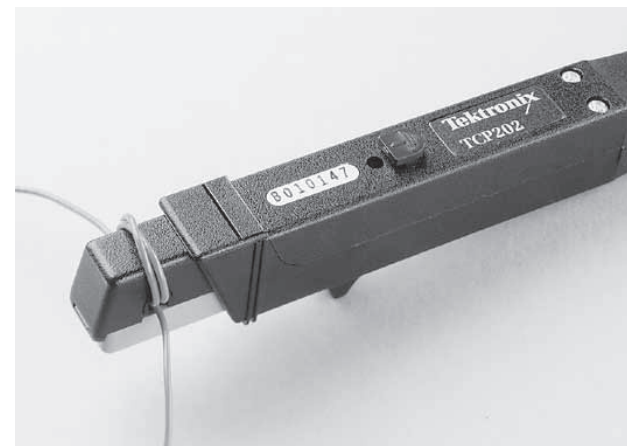
图 2.8. 分芯 AC 电流探头实例。在探头上把导线绕 n 圈，可以使有效的灵敏度提高 n 倍。
