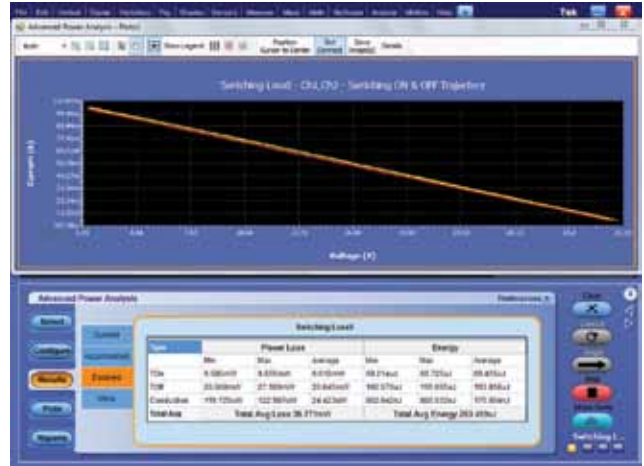
图 6. DPOWPR 可以显示多个周期上打开过程中 (黄色轨迹) 和关闭过程中 (红色轨迹) 电压相对于电流的关系, 查看这些特点怎样随时间变化。这条电路的打开和关闭慢且均衡, 因此示图是线性的。
