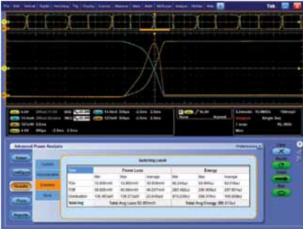
图 5. DPOWPR 自动开关损耗测量。
