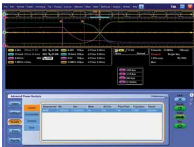
图 7. 自动测量 MOSFET 栅极转换速率。
