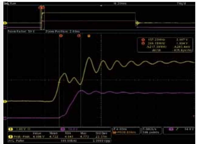
尽管低端开关假设参考“地电平”，但可以看到实际波形及其对高端性能的影响。图 8 显示由于低端开关、高端栅极和开关节点之间的寄生耦合，低端开关有铃。
