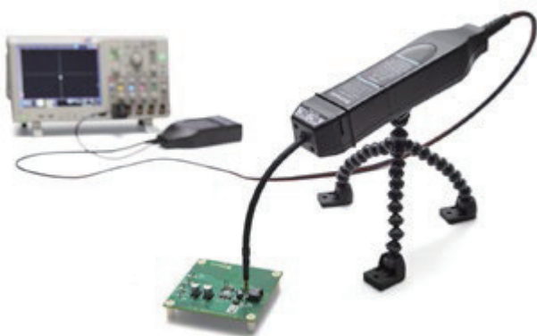
图3: IsoVu测量系统。
