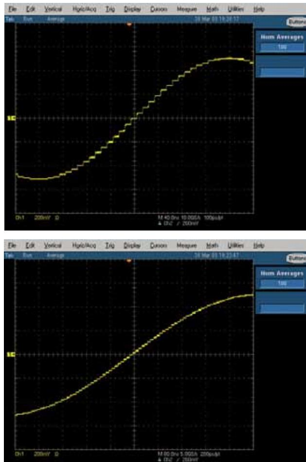
图 25. (上) 垂直分辨率低；(下) 垂直分辨率高。垂直分辨率决定着复现的波形的幅度精度。
