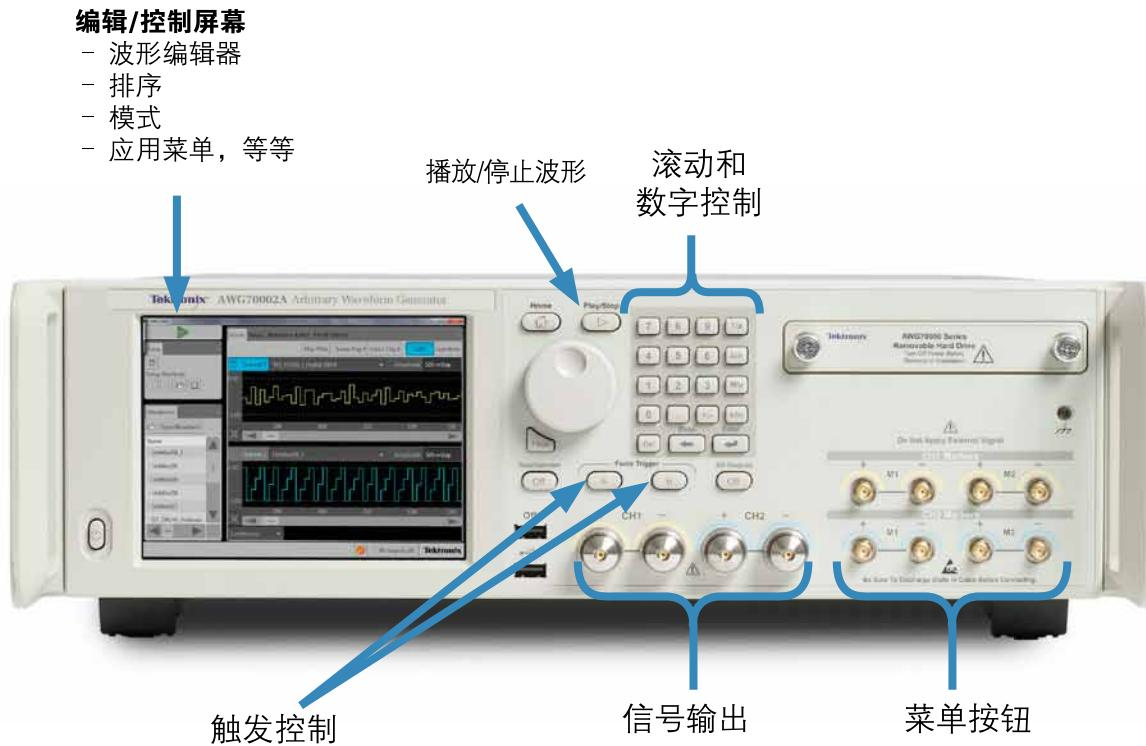
图 19. 高性能混合信号发生器：泰克 AWG7000 系列任意波形发生器。
