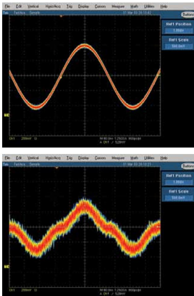
图2. (上) 理想的波形；(下) “实际环境” 波形。通用信号发生器可以为器件极限测试和检定提供受控的失真和畸变。
