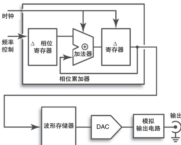
图 16. 任意波形 / 函数发生器的结构 ( 简图 )。
