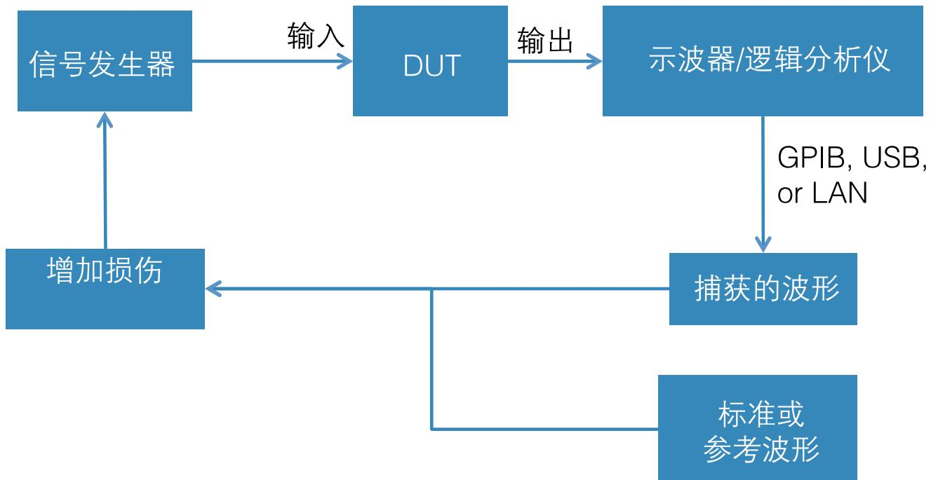
图 3. 信号发生器可以使用标准波形、用户创建的波形或捕获的波形，在需要的地方对专门测试应用增加损伤。
