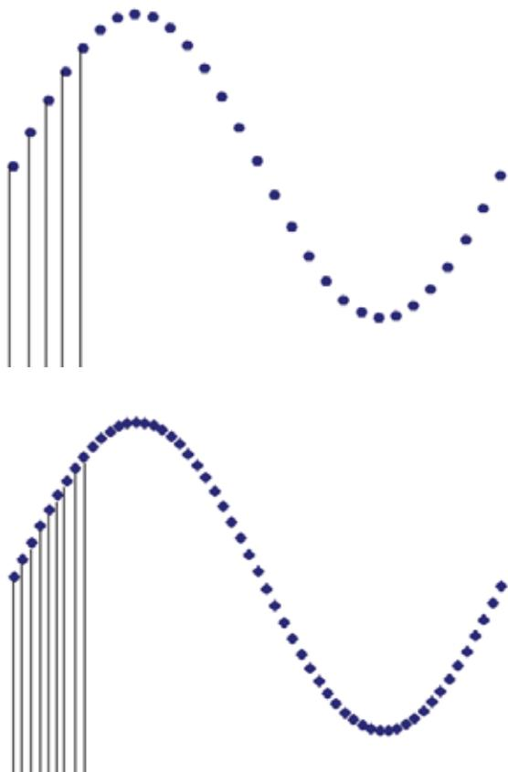
图 26. (上) 水平分辨率低；(下) 水平分辨率高。水平或定时分辨率是指边沿、周期时间或脉宽可以变动的最短时间增量。
