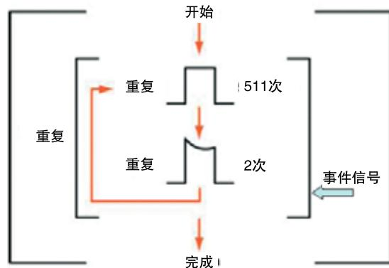
图 31. 可以使用循环和重复扩展 AWG 的波形存储器容量。
