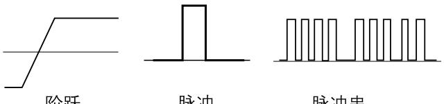
图 11. 阶跃、脉冲和脉冲串形状
