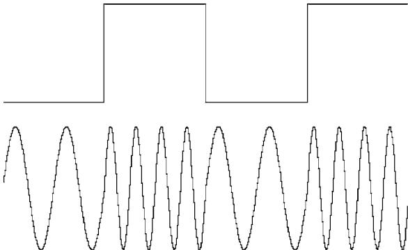
图 13. 频移键控 (FSK) 调制
