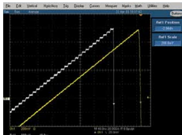
图 30. 滤波前和滤波后。参考 1 (上) 波形是没有滤波的锯齿波形，通道 1 (下) 波形是滤波后的锯齿波形。
