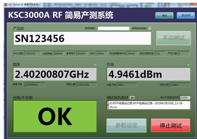
KSC-3000A 操作简单，可搭接 RSA306B、RSA500 或 RSA600 三种 USB 频谱分析仪使用。客户可根据自己的购买能力和测试指标需求选择不同的仪器来完成测试。
