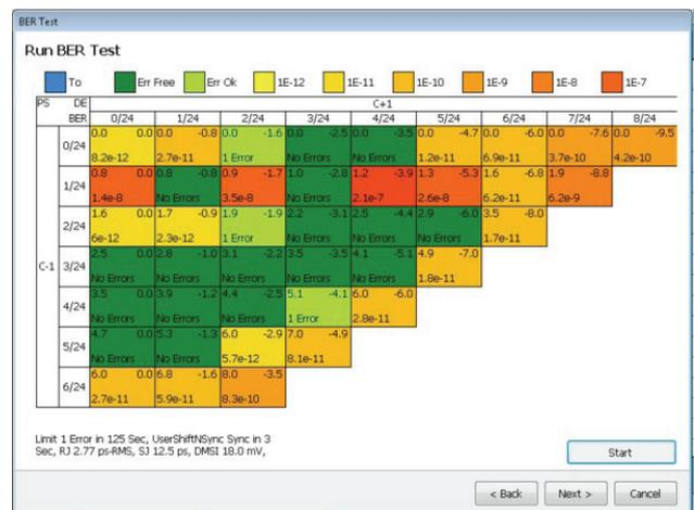
图 12. 对 Tx EQ 的系数空间进行扫描的误码率测试
