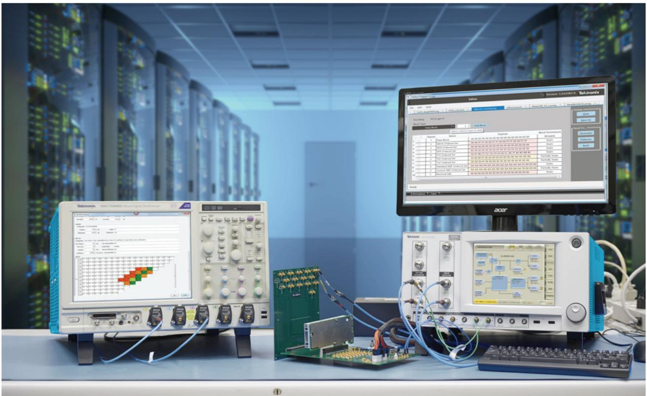
图 1. PCIe 3.0 的接收端测试的示意图
