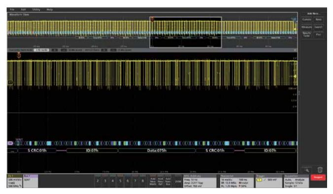
解码后的 SENT 总线可以在一个波形画面中显示快速和低速 通道包, 低速通道包显示在快速通道包的下面。
