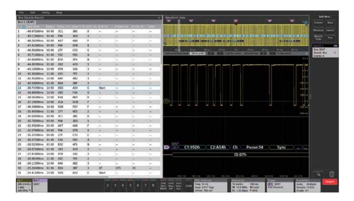
对固件工程师, Results Table 格式可能会更实用。这种总线活动画面带有时间标记,可以简便地与软件列表进行对比,可以简便地计算执行速度。
