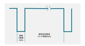
SENT 在两个下降沿之间用 4 位蚕食(nibble)传输数据,因而得名 "Single Edge Nibble"(单一边沿蚕食)。 SENT 总线的定时单位是滴答(tick), 1滴答(tick)—般宽 3 μs。每个蚕食开头都有一个最少 5滴答(tick) 的逻辑低周期,然后是长度可变的逻辑高周期,表示编码后的数据值。二进制数据值 0000 用 12 滴答的逻辑高 持续时间表示。二进制数据值 0001 用 13 滴答的逻辑高持续时间表示,依此类推,二进制数据值 1111 用 27 滴 答的逻辑高持续时间表示。
