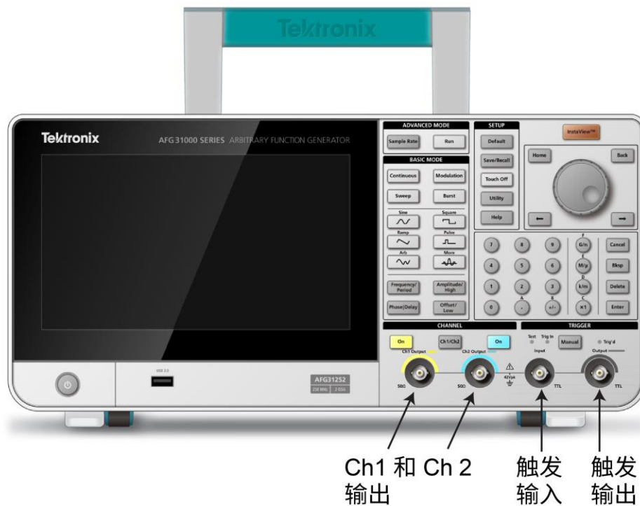
图 2：AFG31000 系列前面板输入和输出
