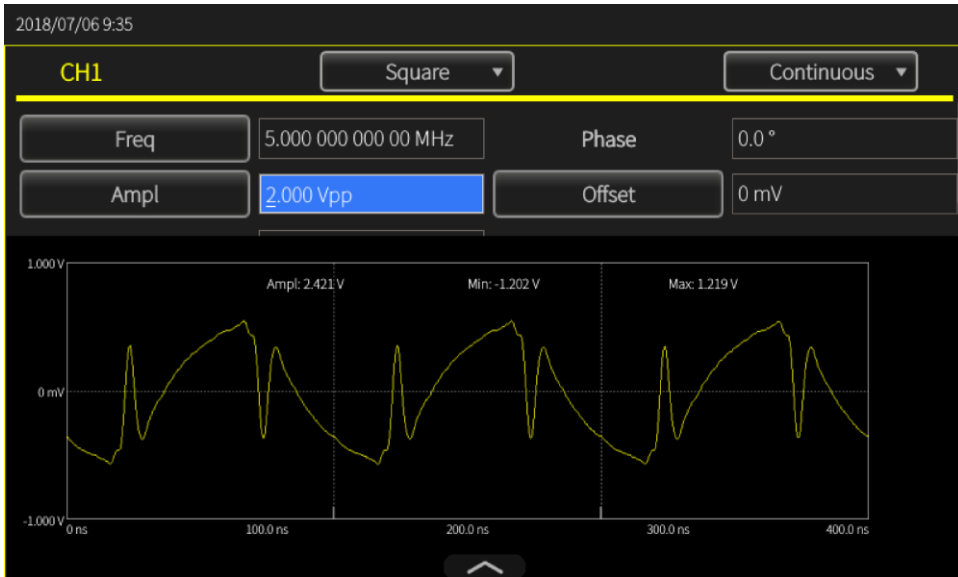
图 74: 幅度 2 VPP – 示波器 InstaView
