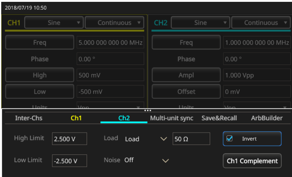
图 48: 反转通道 1 和通道 2 波极性
