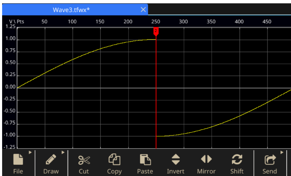
图 132: ArbBuilder 突出显示要剪切的波形数据
